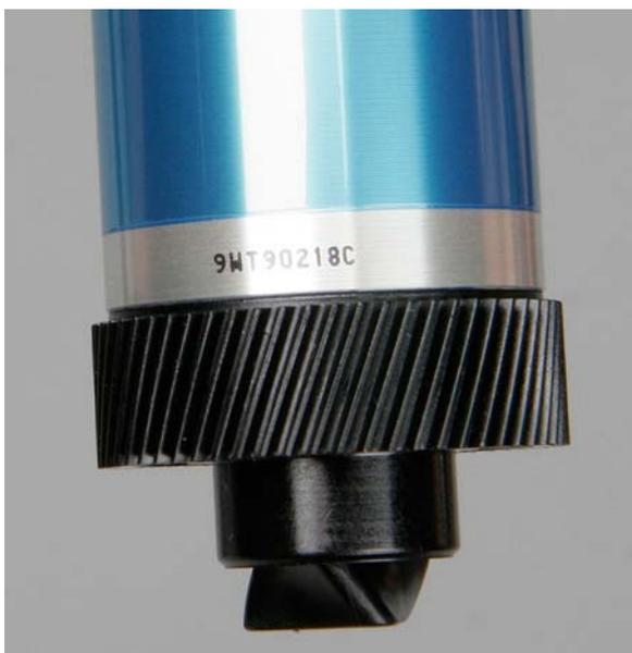
**5.** На поверхности барабана есть маркировка партии изготовления. Маркировка выполнена струйным принтером.
