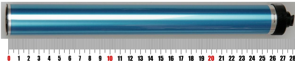
3. Покрытие на барабане прозрачное (свет отражается от алюминиевой поверхности барабана), это покрытие имеет при обычном освещении голубые оттенки. Общая длина барабана 283 мм.
